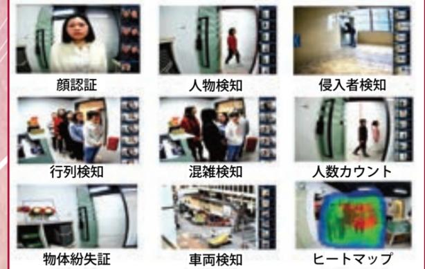
本システムは IP 方式の高解像度監視システムに AI 機能を搭載しております。人物の顔、人体、車両を認識させることにより、音声アナウンスやアラーム出力、Eメール送信を行うことが可能です。
