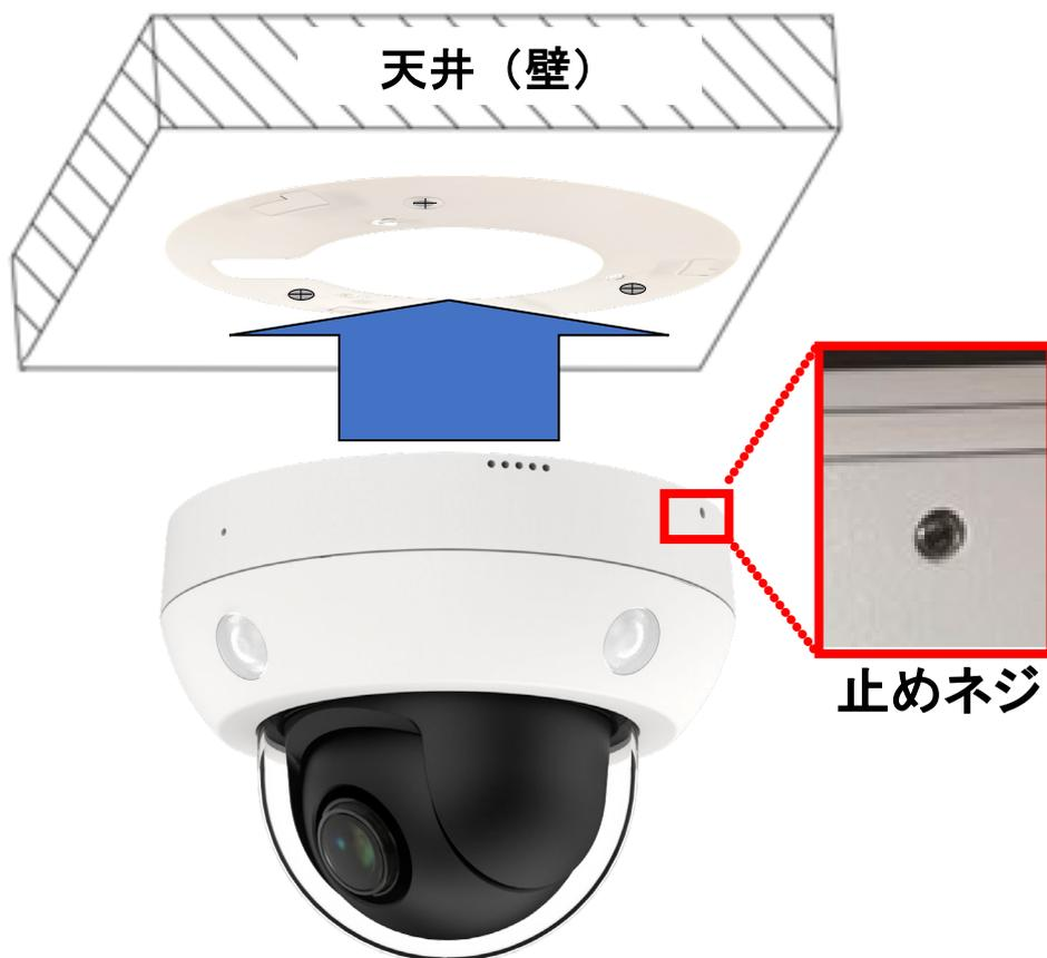
図3-4 カメラベースにカメラ本体を固定
